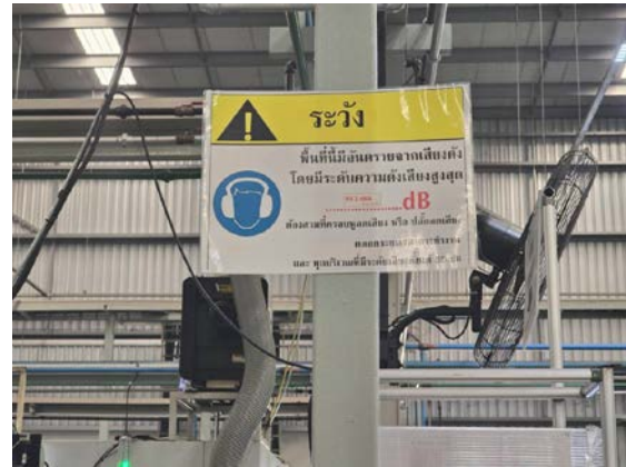
รูปที่ 2-2 ป้ายเตือนพื้นที่ปฏิบัติงานที่มีเสียงดังตั้งแต่ 85 เดซิเบล(เอ)
